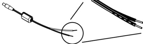
・DCケーブルで電源供給する場合、フェライトコアを取り付けることで、他機器に与えるノイズや他機器より受けるノイズを軽減することができます。付属のDCケーブルをご使用の際には、付属のフェライトコアを下図のように巻きつけてください。
